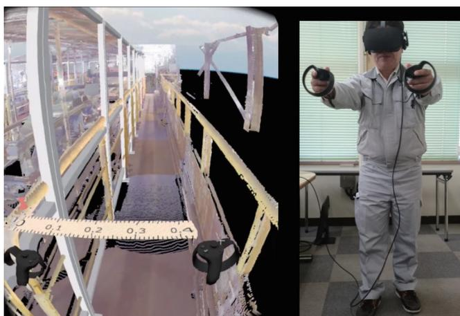
図4: 点群VRでの寸法計測風景
