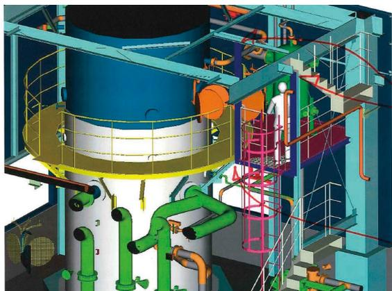
図8：詳細設計時の機器と配管干渉及び操作性の検討例
