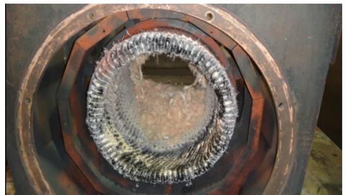
図4:蒸焼後固定子(灰化)
