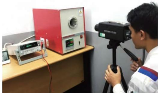
写真4：放射温度計の校正
