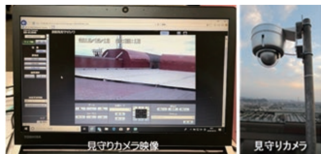
図13: 現場監視用見守りカメラの設置
