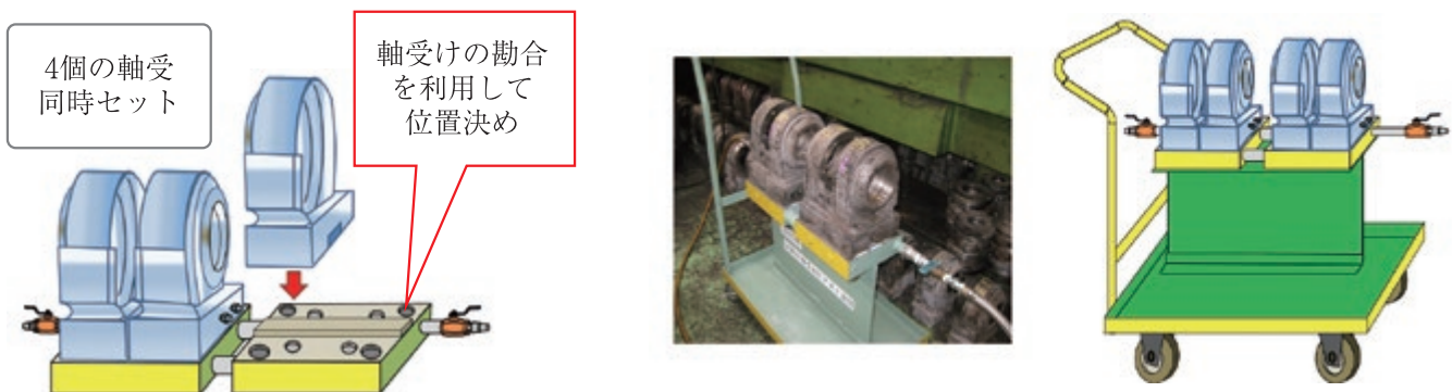
図4: 改善後の軸受け水圧試験方式
