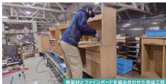
無垢材とファインボードを組み合わせた完成工程
