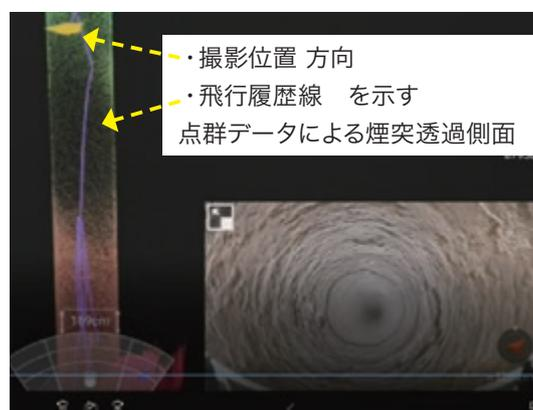
図4：煙突 GL+112M付近 内側画像
