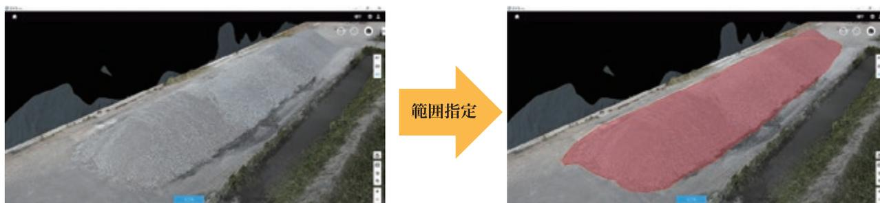
図2：原料山の体積測量（日本製鉄株式会社 室蘭地区）
