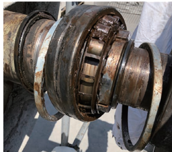
図8:取り外した自動調芯コロ軸受
