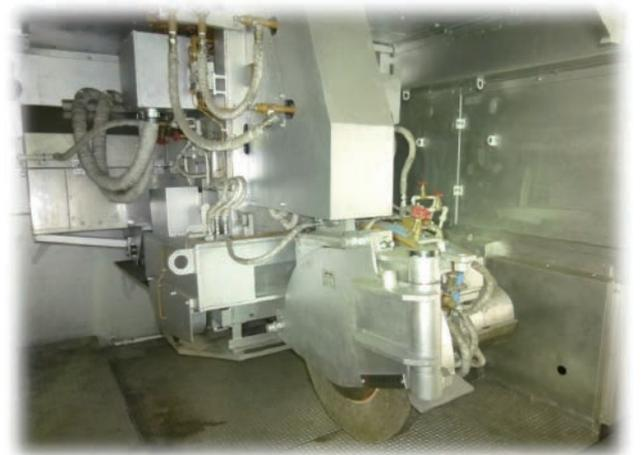
図12. 150kW 砥石軸ユニット(1軸構造)
