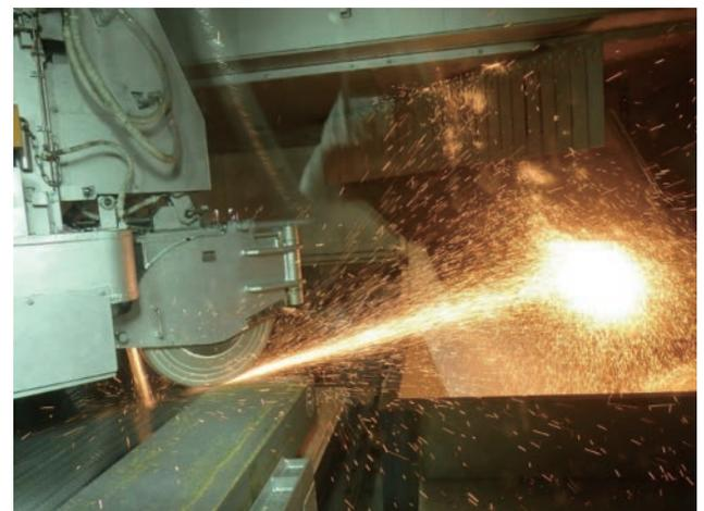
図3: スラブ研削中の砥石軸ユニット
