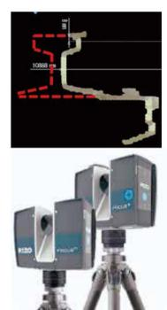
レールの芯ずれと勾配を実測して補修計画をご提案
