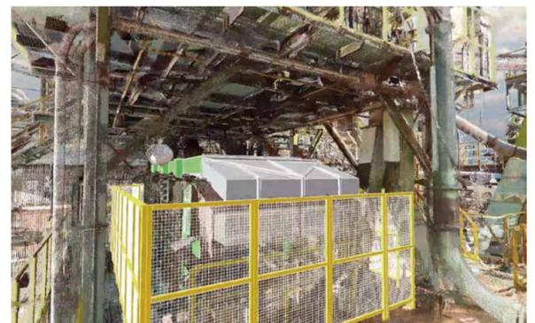
既設点群データ内に新設3Dモデルを入れて干渉確認
