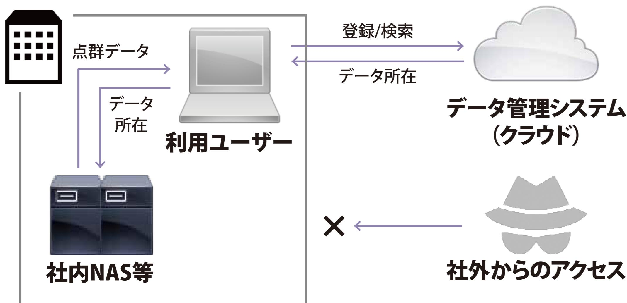
データ保管先をショートカットとして登録するため、オンプレ・クラウドどちらもOK(混在可)データ取り扱い契約等でクラウド保管が禁止されている場合にも対応できます。
