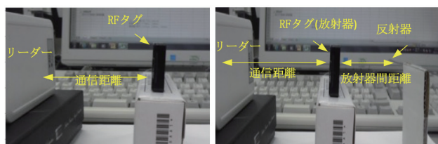
図8:RFタグ単体通信距離およびRFタグ+反射器通信距離測定
