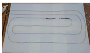
シート内部にフレキシブルアンテナ2本敷設
