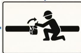
補修テープ巻き付け
