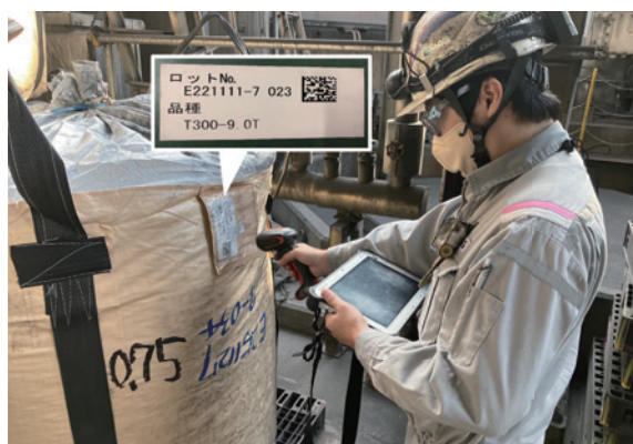
図4: 出荷時のフレコンカード読み取り手順
